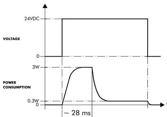
Le valvole delle tipologie dotate di speed-up hanno prestazioni di portata e di tempo di risposta elevatissime nonostante il consumo di potenza sia molto piccolo. Quando arriva il comando viene erogata una grande potenza per un breve periodo, sicchè la valvola commuta rapidamente. Successivamente viene erogata una potenza di mantenimento in posizione, circa 10 volte più piccola. Con questa soluzione anche la temperatura della valvola resta molto bassa.
